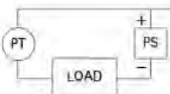
图 3c 变送器的正端和电源之间接地
