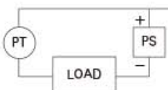
图 3c 变送器的正端和电源之间接地
